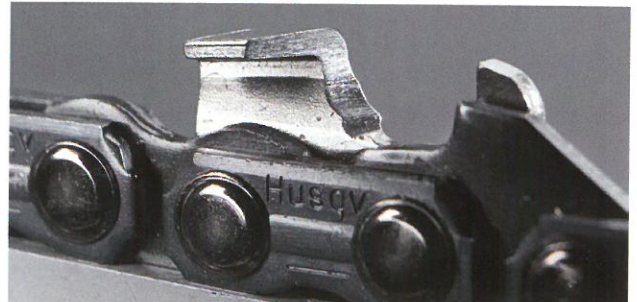
Tänapoole kaldus nurk. Löikehammas on liiga kõrgeks viilitud ning löikab halvasti. Kasutage teritusmalli ja teritage löikehammas vastavalt soovitudele uuesti.
