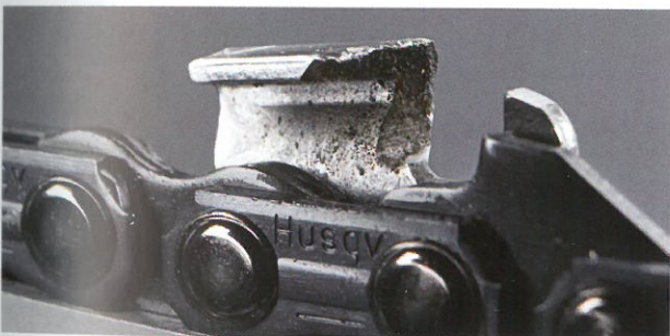
Löikehammas, mis on kivi löiganud, on ebaühtlase servaga kohas, kus hamba peamine kiht on kahjustada saanud. Et kett oleks võimalikult terav, tuleb kõik kahjustused ära viilida.
